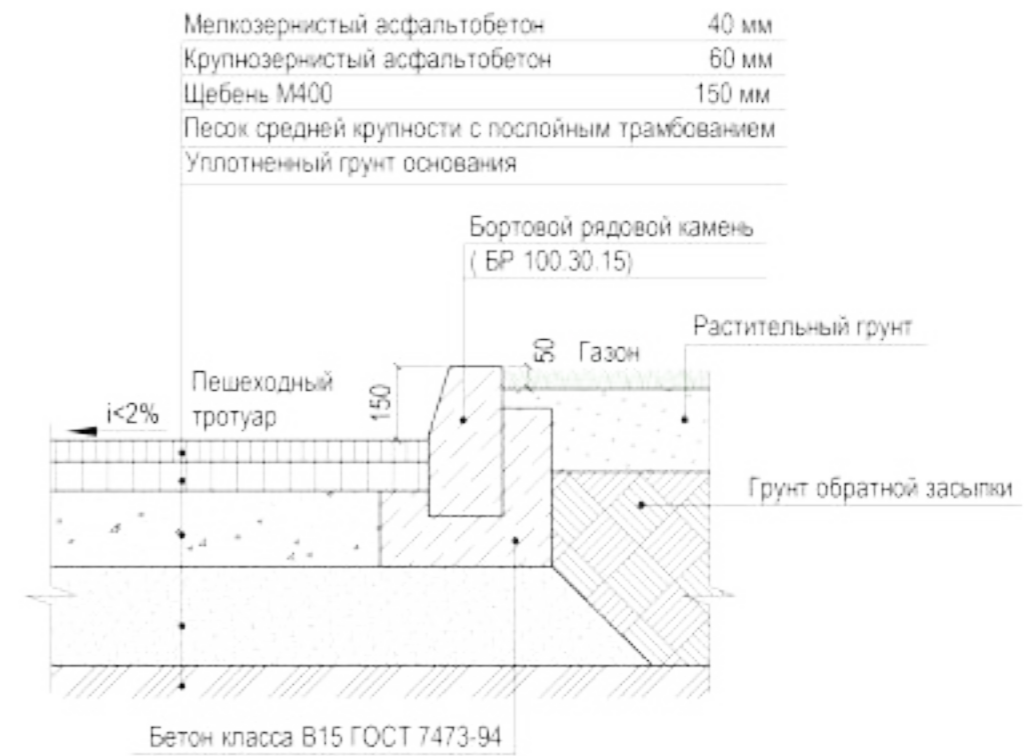
3.13.1 Схема устройства сопряжения асфальтобетонного покрытия и газона
